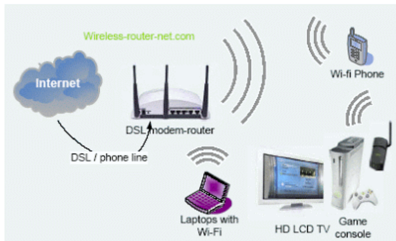
Gambar 6.3 Jaringan nirkabel yang menggunakan wireless access point
