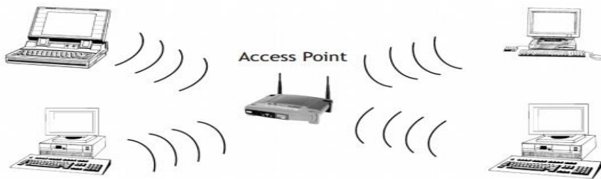
Gambar 6.2.Mode Jaringan Infrastruktur topologi infrastruktur
